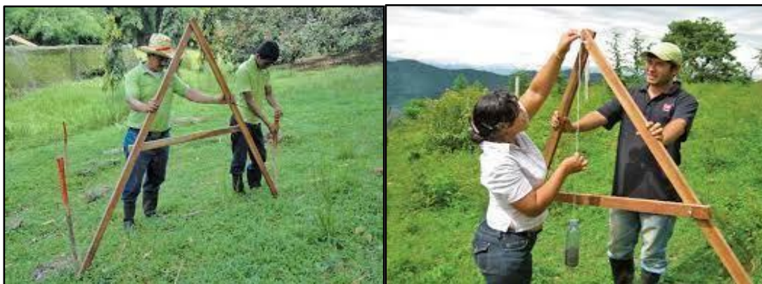
Figura 4.9. Exemplos de marcação de curva de nível com utilização de pé-de-galinha.
